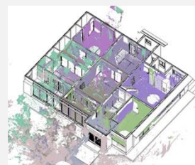
点群データからのモデル生成／BIMを活用した改修設計とは(住宅医協会HP)より
